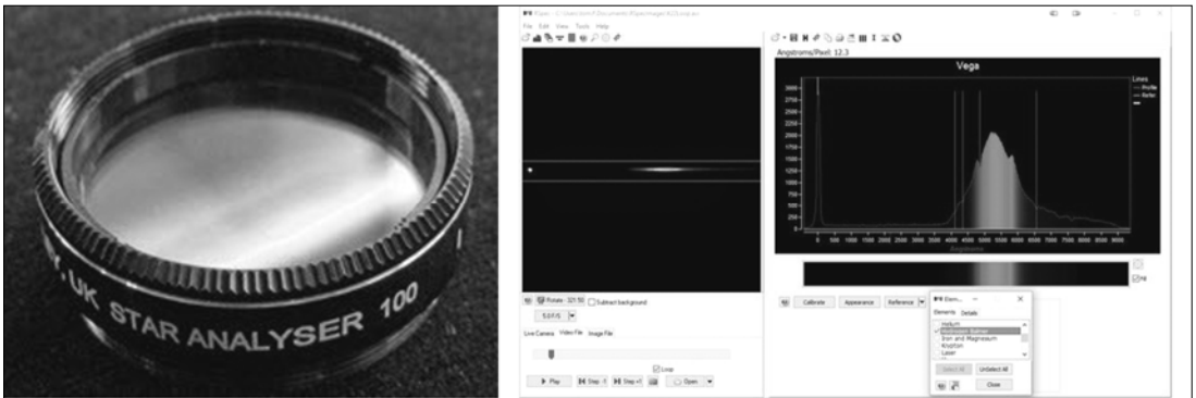
Слика 1. Трансмисиона дифракциона решетка SA-100 и приказ софтвера RSpec.
