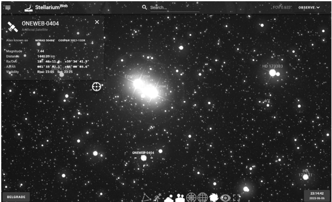
Слика 2. Идентификација непознатог вештачког сателита коришћењем интернет алата Stellarium. Испод система \epsilon Lyr, уочава се вештачки сателит под ознаком ONEWEB-0404, чије су карактеристике дате у горњем левом углу слике. Извор: Stellarium.
