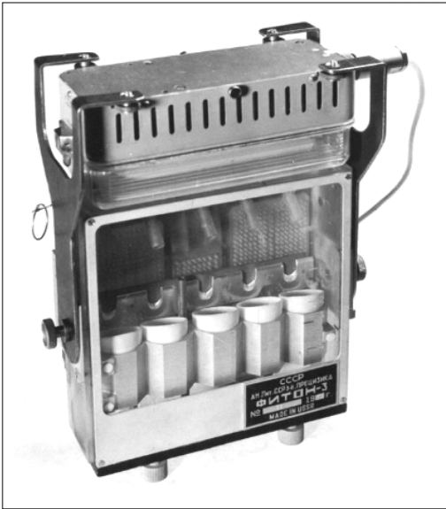
Слика 3. Приказ совјетског инкубатора Фитон-3 у коме се 1982. године одвило прво цветање у космосу. Извор: Lietuvos etnokosmologijos muziejus.
