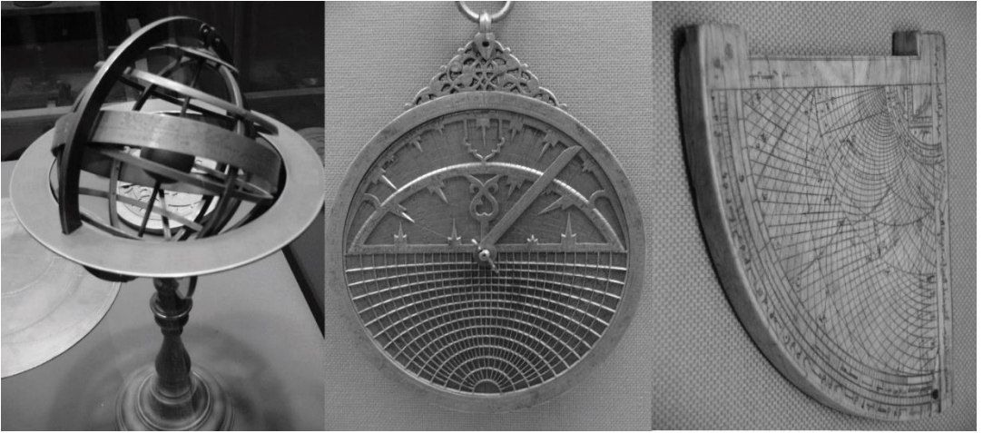
Слика 6: Слева на десно: армиларна сфера, астролаб (предњи део) и квадрант (без казаљке, чије лежиште је доле десно).
