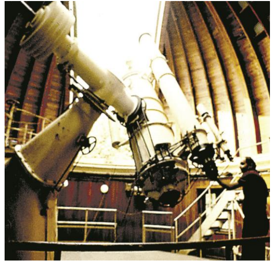
Слика 6: На опсерваторији у Будимпешти, од 1928. године налази се телескоп „Heyde-Zeiss” са огледалом од 60 cm. На њега је постављен рефрактор „Zeiss” са објективом од 30 cm; ово је највећи рефрактор у Мађарској.
