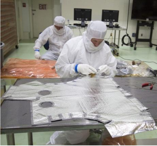
Слика 5: Поред оклопа против зрачења потребан је и топлотни оклоп за одржавање радне температуре опреме.
