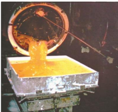
Слика 5: Ливење оптичког стакла у велике блокове у погонима Цајса у Јени.
