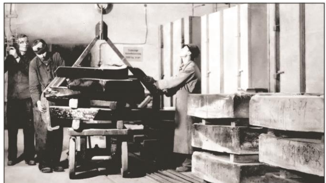
Слика 5: Ливење оптичког стакла у велике блокове у погонима Цајса у Јени.
