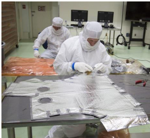
Слика 5: Поред оклопа против зрачења потребан је и топлотни оклоп за одржавање радне температуре опреме.
