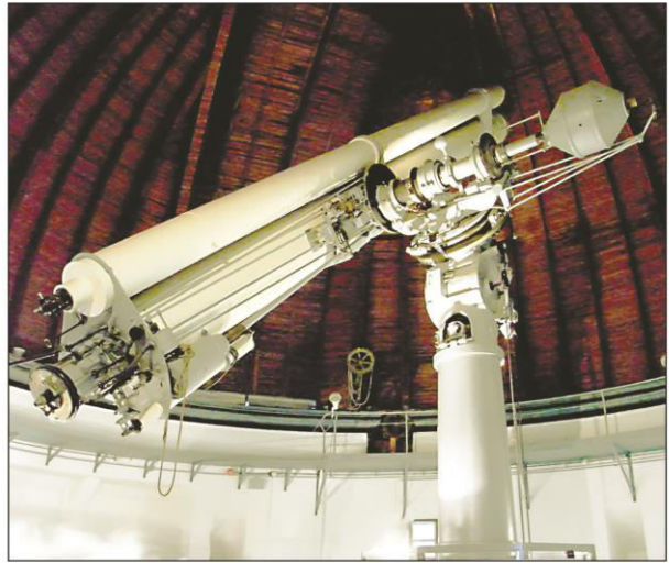
Слика 7: „Брат близанац” београдског великог рефрактора. Налази се у Токију, на опсерваторији Митака. Идентичан је по свим техничким карактеристикама београдском, осим што се паралелно уз његов тубус са објективом од 65 см налази монтиран и рефрактор са објективом од 38 см и жижне даљине 10,83 т.
