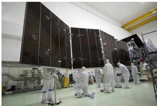
Слика 2: Једна од три соларне плоче за електрично напајање уређаја.
