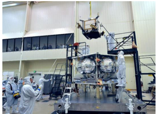
Слика 4: Титанијумско кућиште је постављено на главно тело сонде где су лоптасти резервоари за маневарско гориво.
