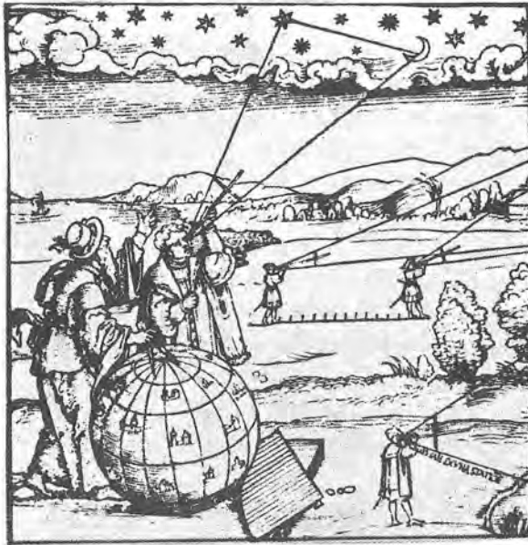
SLIKA 54 - Merenje daljine komete od zvezda pomoću Jakovljeveg štapa
