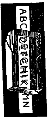
Fig. 1034. Doppelbrechung des Kalkspates.
