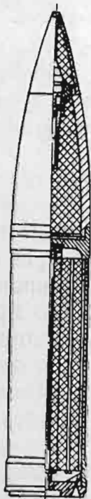
Фиг. 2.3. Снаряд осколочно- фугасного действия.
