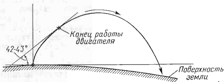
Фиг. 2. 19. Вид траектории баллистической ракеты дальнего действия.
