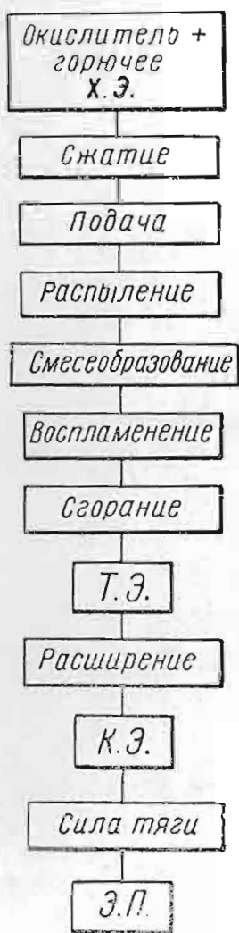
Фиг. 3.1. Схема преобразования энергии в ракетных двигателях прямой реакции.
