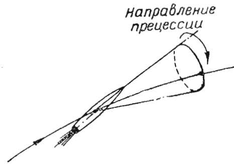
Фиг. 9.15. Прецессия турбореактивного снаряда.
