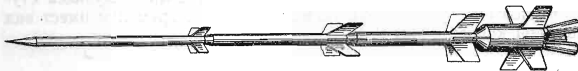
Фиг. 2. 10. Пороховая многоступенчатая ракета дальнего действия.
