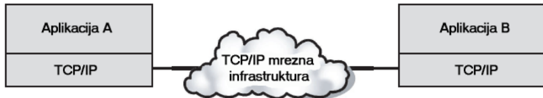
slika 4.17. Komunikacioni kanal i stek protokola za TCP/IP
