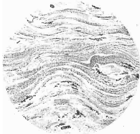
Sl. 794. Izbrusak liparita od Mozdjenca u Hrvatskoj posmatran pod mikroskopom. Fluidalna tekstura.
