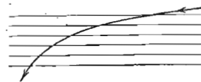
Sl. 170. Savijanje svetlosnog zraka pri promeni indeksa prelamanja. n opada odozdo naviše.
