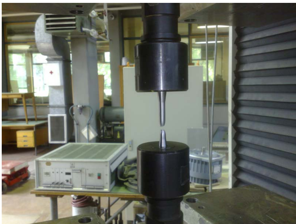
Слика 7.12 Испитивање на уређају МТС-у епрувете на замор за одређивање цикличних карактеристика материјала
