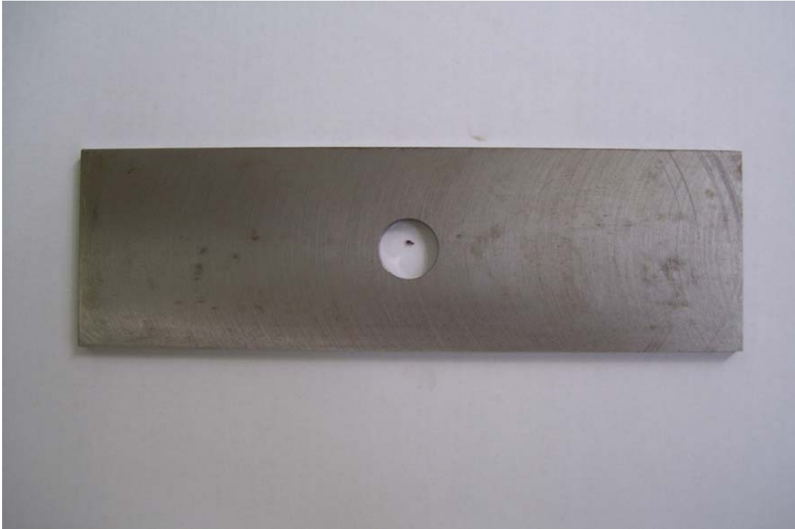
Слика 7.3 Епрувета са отвором као репрезент структуралног елемента за одређивање броја циклуса до појаве иницијалне прскотине
