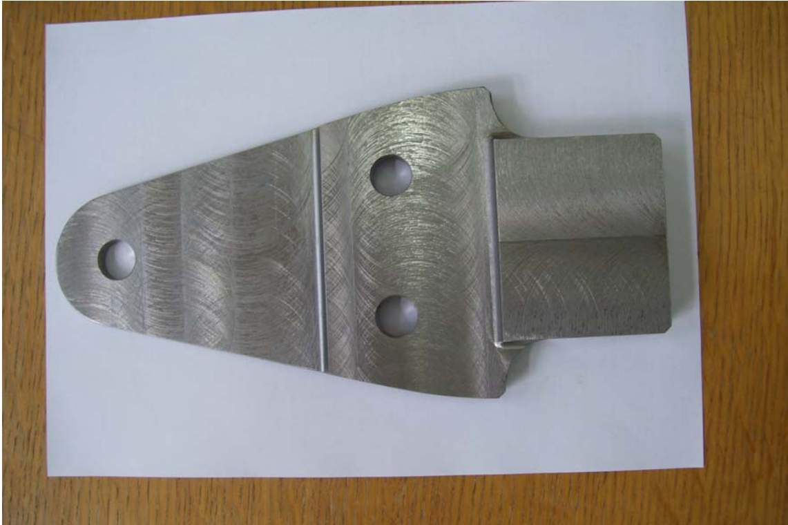
Слика 7.5 Реална епрувета полу-окова лопатице за одређивање броја циклуса до појаве прскотине
