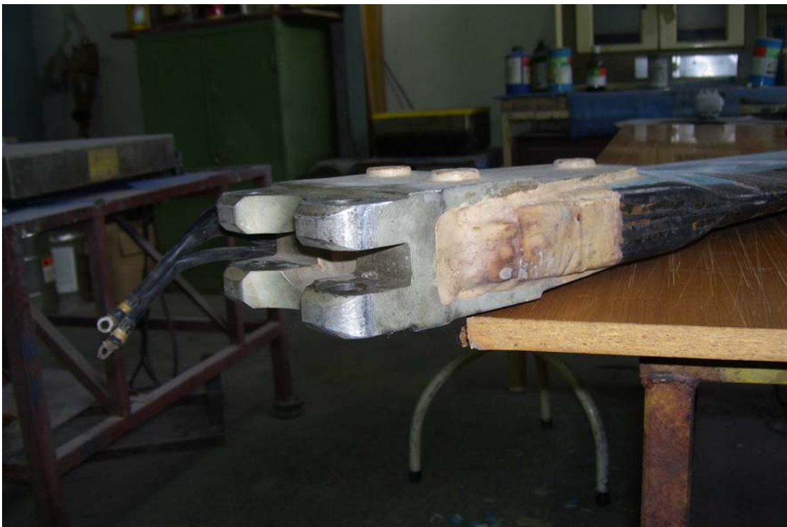
Слика 7.6 Оков у склопу са прототипском лопатицом репног ротора хеликоптера ХТ40
