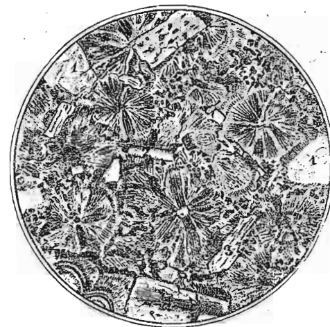
Слика 38. — Микроскопски препарат сферолитног фелсо-дацита са виса измеђ Бруснице и Такова.
