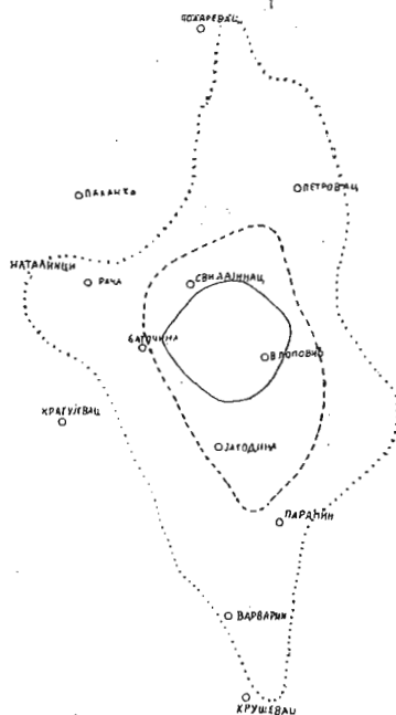
Слика 12. представља област и начин распрострањења потреса од 20. Јуна 1910. г. чије је средиште било у Ресави. У средини је целом линијом заокружљени простор најјачега удара: плеистосеиста. Испрекиданом цртицама означена је прва изосеиста, а тачкицама је обележена крајна линија потреса.
