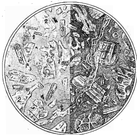
Слика 37. — Микроскопски препарат хијалодацита из Даросаве.
