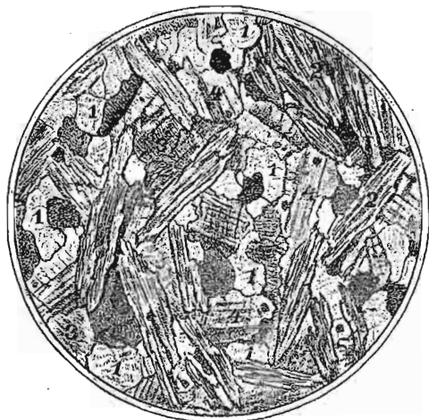
Слика 39. — Микроскопски препарат гранулиита са Цера.
