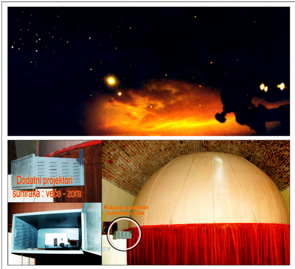
Слика 8: Специјано направљен пројектор за ефекат сумрака (вече-зора).
